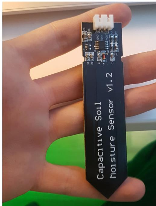
*Abbildung 11: Der Sensor zum Messen der Bodenfeuchtigkeit*
