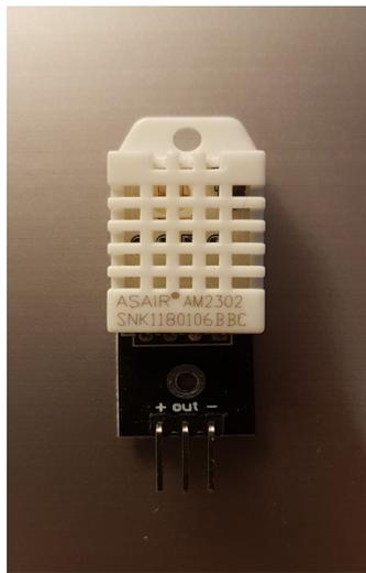
*Abbildung 10: Der Sensor zum Messen der Temperatur und der Luftfeuchtigkeit*
